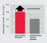
FIG. 2 - INSULATION RESISTANCE (@ DC 1,000V)
