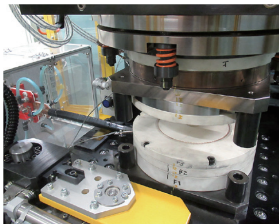
高周波式 摩擦材接着設備
